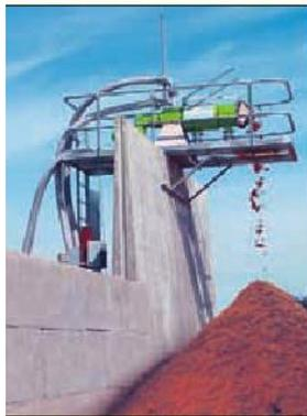
Der Separator S 655 S 855 aus dem Hause Bauer, Voitsberg, ermöglicht die vollautomatische Trennung von Abfallsubstrat in eine flüssige und feste Phase. Sowohl in der Gülleaufbereitung als auch in der Industrie, wie in der Pharma- und Lebensmittelindustrie, in Schlachtbetrieben oder Brennerien,
